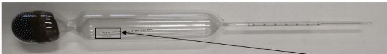
Рисунок 13 – Общий вид ареометров стеклянных АМВ
