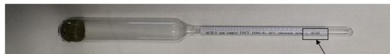
Рисунок 10 – Общий вид ареометров стеклянных АСП-3
