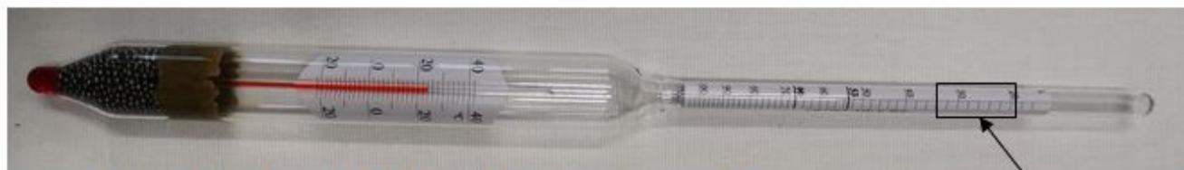
Рисунок 12 – Общий вид ареометров стеклянных АЭГ
