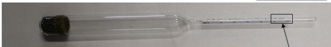
Рисунок 3 – Общий вид ареометров стеклянных АН
