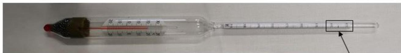
Рисунок 2 – Общий вид ареометров стеклянных АНТ-2
